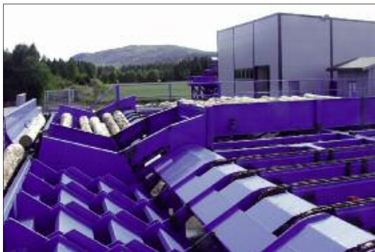
Saglinjen er noe bygget om siden 1974, og består av en tømmertagende reduserbåndgruppe og en redusersirkelgruppe for oppdeling.
