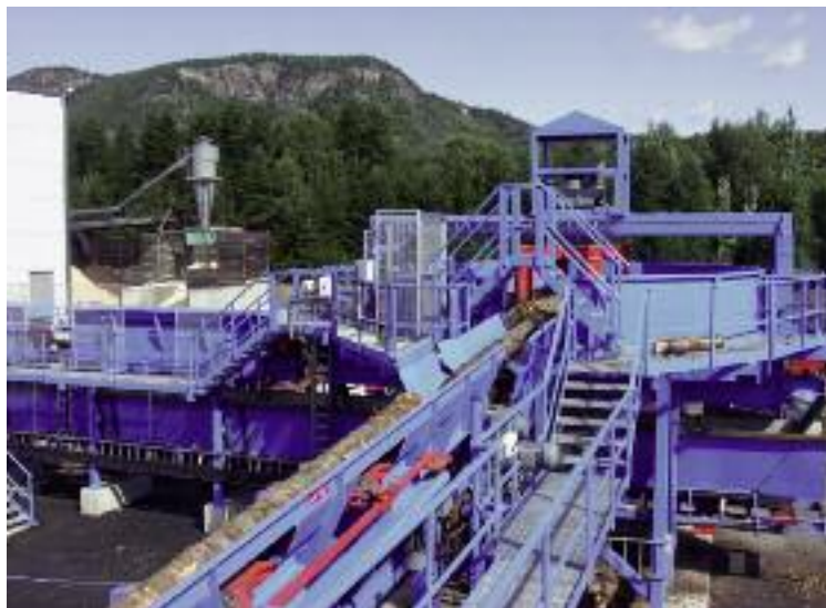
Etter måling av topp og rot går stakkene inn i en vender som sørger for at alle går med toppenden inn i sagen.
